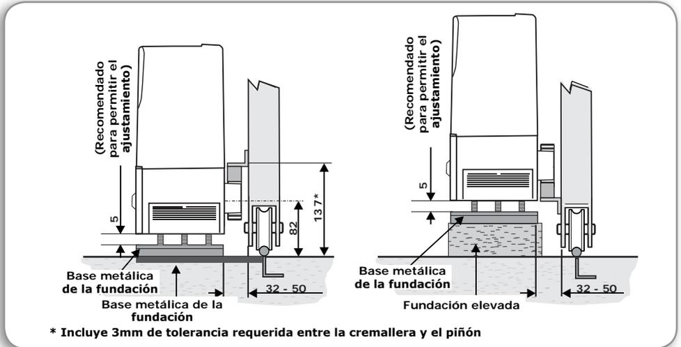
FIGURA 10A CREMALLERA DE NYLON CON SOPORTE DE ACERO ANGULADO, SOBRE EL PIÑÓN
