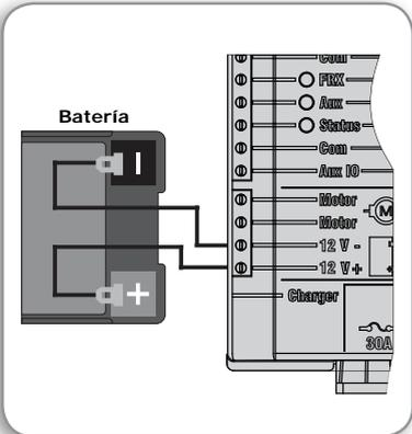
FIGURA 45 CONECCIÓN ESQUEMÁTICA DE LA BATERÍA
