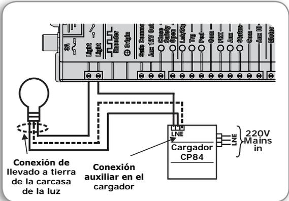
FIGURA 46 CONECCIÓN ESQUEMÁTICA DE LA LUZ
