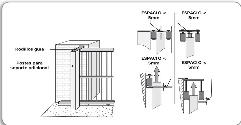
FIGURA 4 MONTANDO LOS RODILLOS GUÍAS
